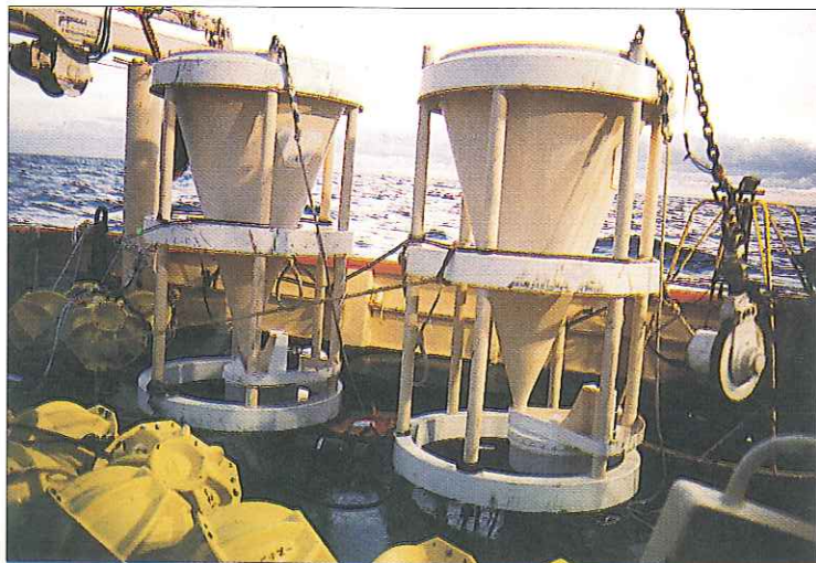
▼ 2 - Les pièges à particules sur le pont du navire océanographique Tethys II .
